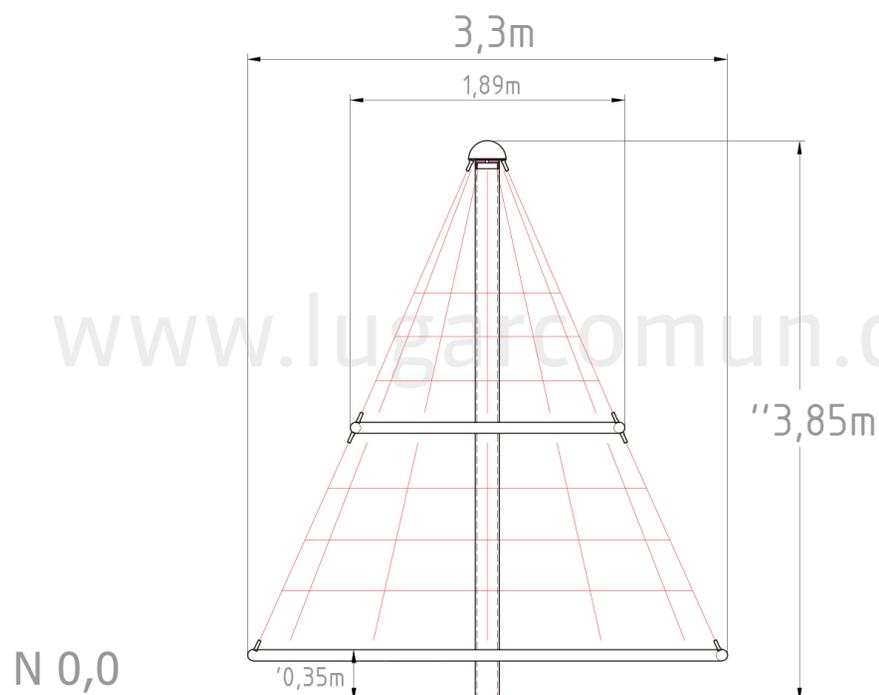
**ESTRUCTURA PRINCIPAL:** Cañería acero galvanizado estructural 139,8 mm
