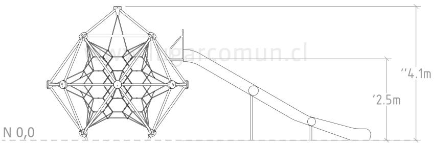
ESTRUCTURA PRINCIPAL: Cañería 3" espesor 3,2mm - Norma ISO 65
