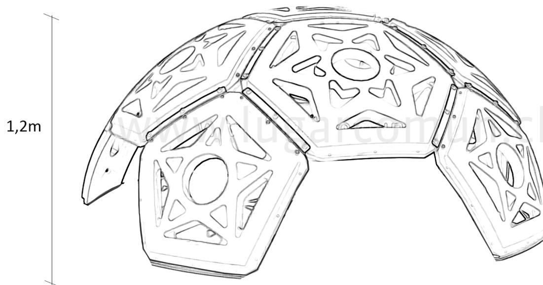
**ESTRUCTURA PRINCIPAL:** Módulo compuesto LLDPE
